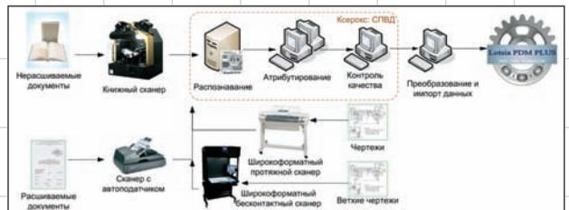
Рис. 27. Технология создания электронного архива технической документации
