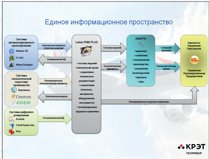
Рис. 6. Роль Lotsia PDM PLUS в едином информационном пространстве ПАО «ТЕХПРИБОР»
