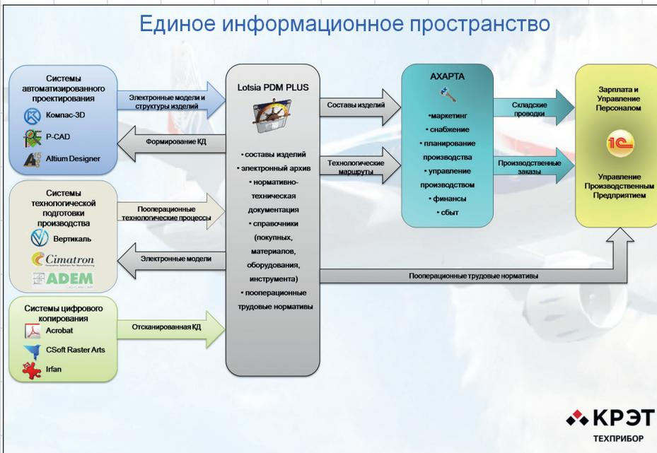
Рис. 5. Роль Lotsia PDM PLUS в едином информационном пространстве ПАО «ТЕХПРИБОР»
