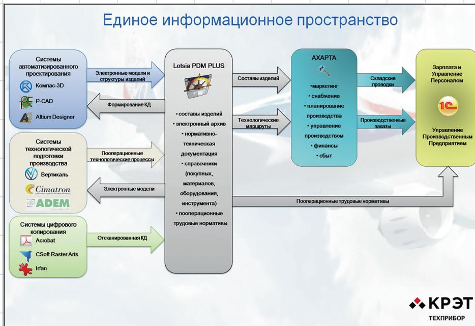
Рис. 7. Роль Lotsia PDM PLUS в едином информационном пространстве ПАО «ТЕХПРИБОР»
