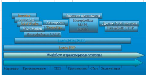
Использование модулей системы Lotsia PLM на разных этапах жизненного цикла изделия
